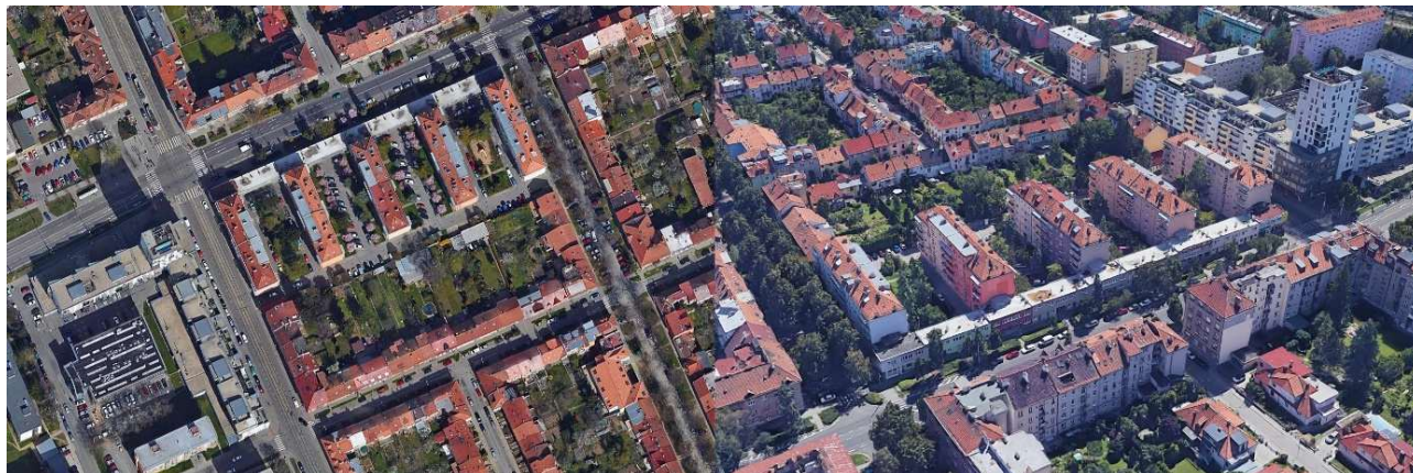
Obr. 24 Příklad volné zástavby v Králově Poli při ulici Skácelova. K nižší souvislé zástavbě jsou do vnitrobloku hřebínkově přistavěny řadové bytové domy se slepými štíty bez oken. Struktura zástavby tvoří veřejně přístupné polouzavřené vnitrobloky.
