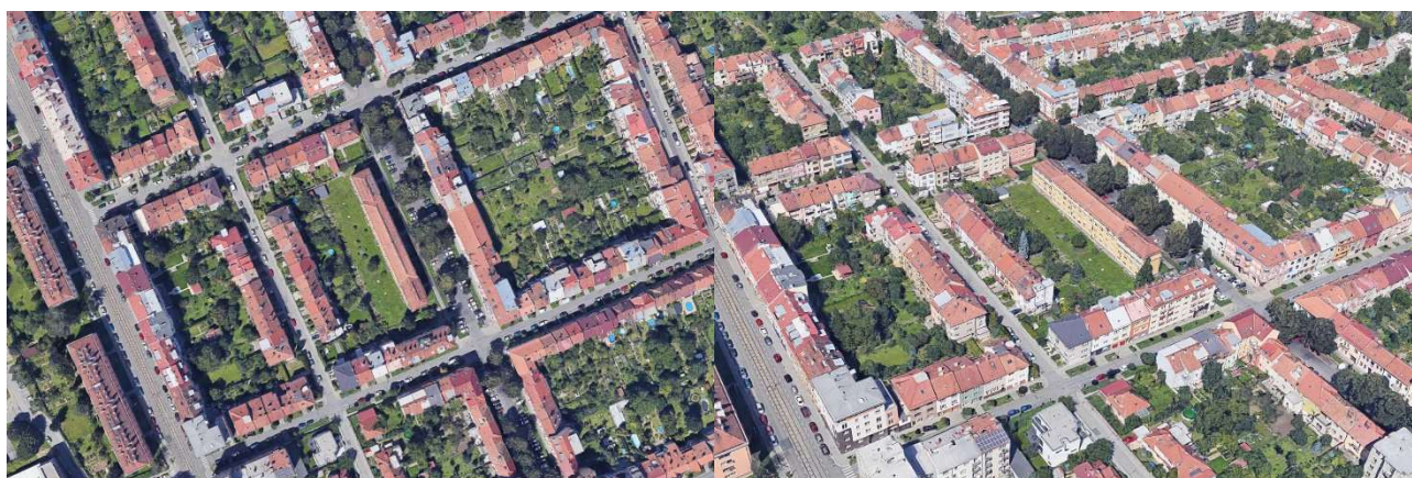
Obr. 20 Na výřezu je znázorněna struktura kompaktní zástavby v Králově Polí. Blok v severní části vymezený ulicemi Berkova, Vodova, Tyršova a Mečřova je příkladem atypického řešení bloku s vnitroblokem rozděleným napůl na poloveřejnou část u bytového domu v ulici Vodova a soukromé zahrádky přiléhající k rodinným domům.
