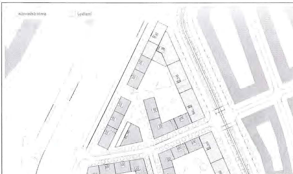
Obr. 5: Schéma rozdělení bloku na administrativní a bytové domy v Ideové urbanistické studii 06/2018
