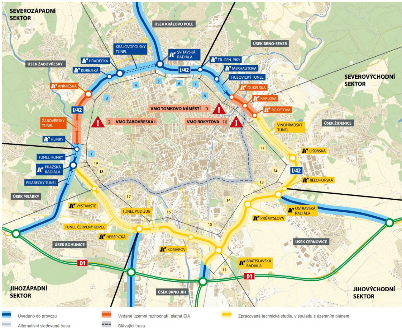
Obr. 80 Stávající stav realizace VMO v Brně (zdroj: mestsky-okruh-brno.cz)
