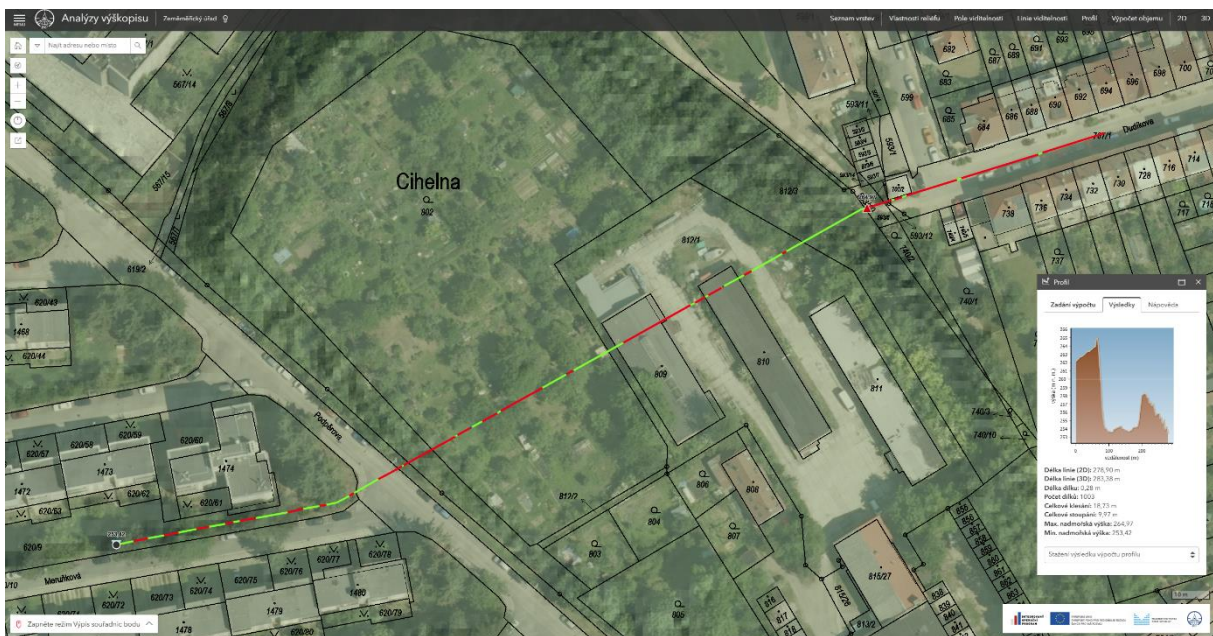
Obr. Řez řešeným územím - analýza výškopisu ČÚZK je podkladem pro ověření požadované výšky objektů
