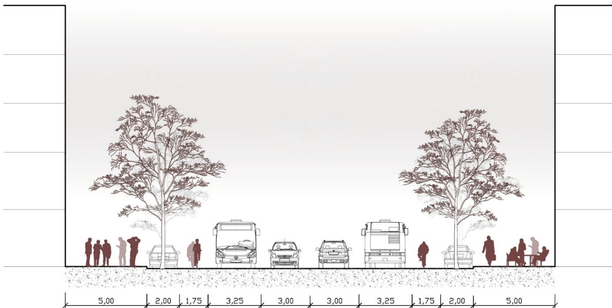
Obr. 15 Příklad možného příčného řezu komunikací Brněnská třída
