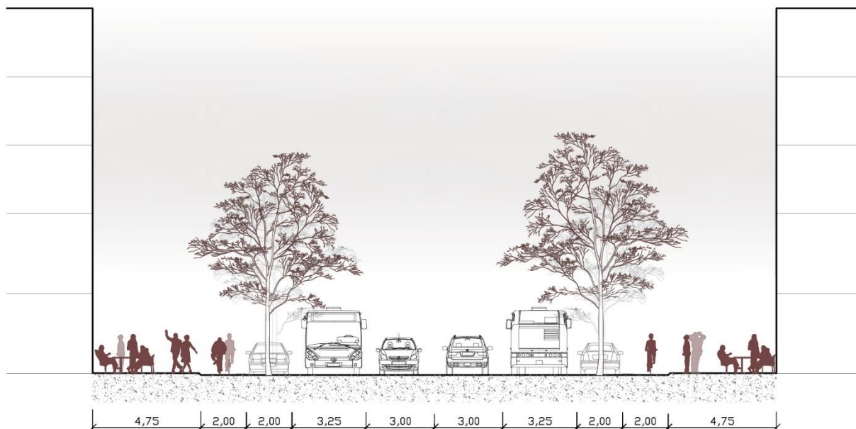
Obr. 18 Řez: možná varianta Brněnské třídy bez středního dělicího ostrůvku a s cyklostezkou umístěnou v přidruženém dopravním prostoru.
