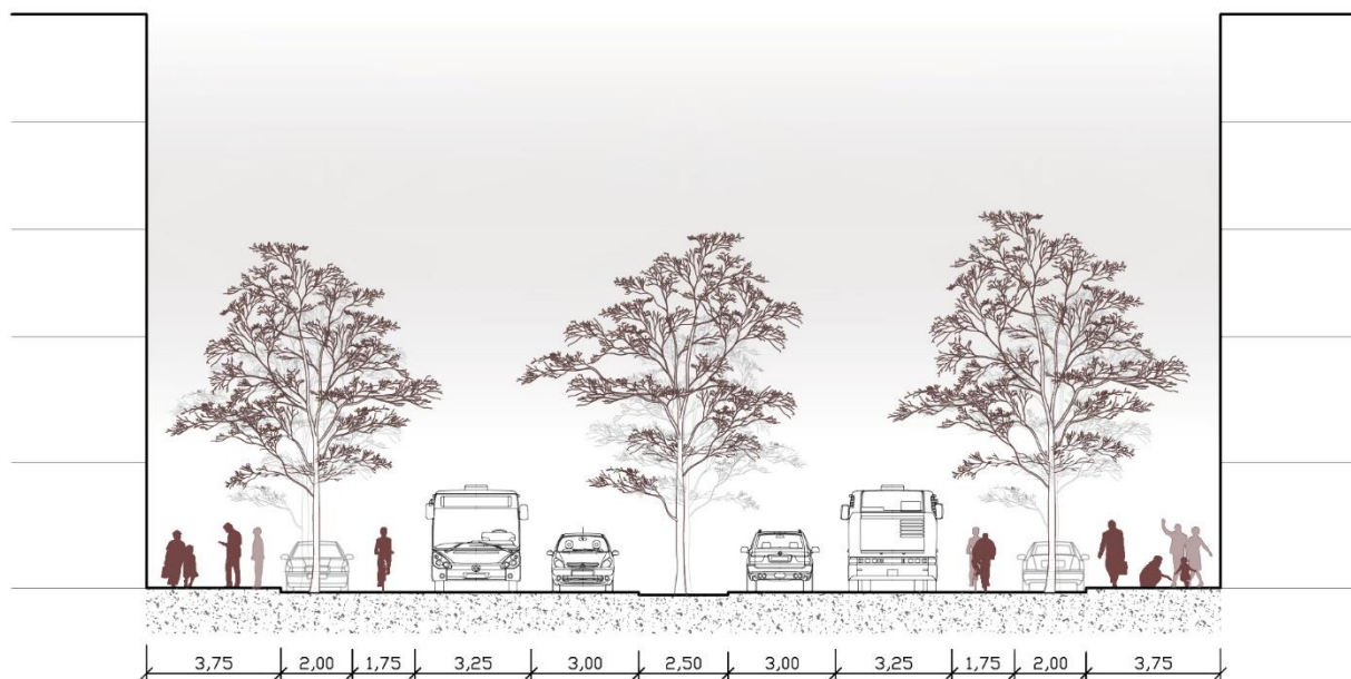
Obr. 17 Řez: možná varianta Brněnské třídy se středním dělicím ostrůvkem v celé délce a s cyklostezkou umístěnou v hlavním dopravním prostoru.
