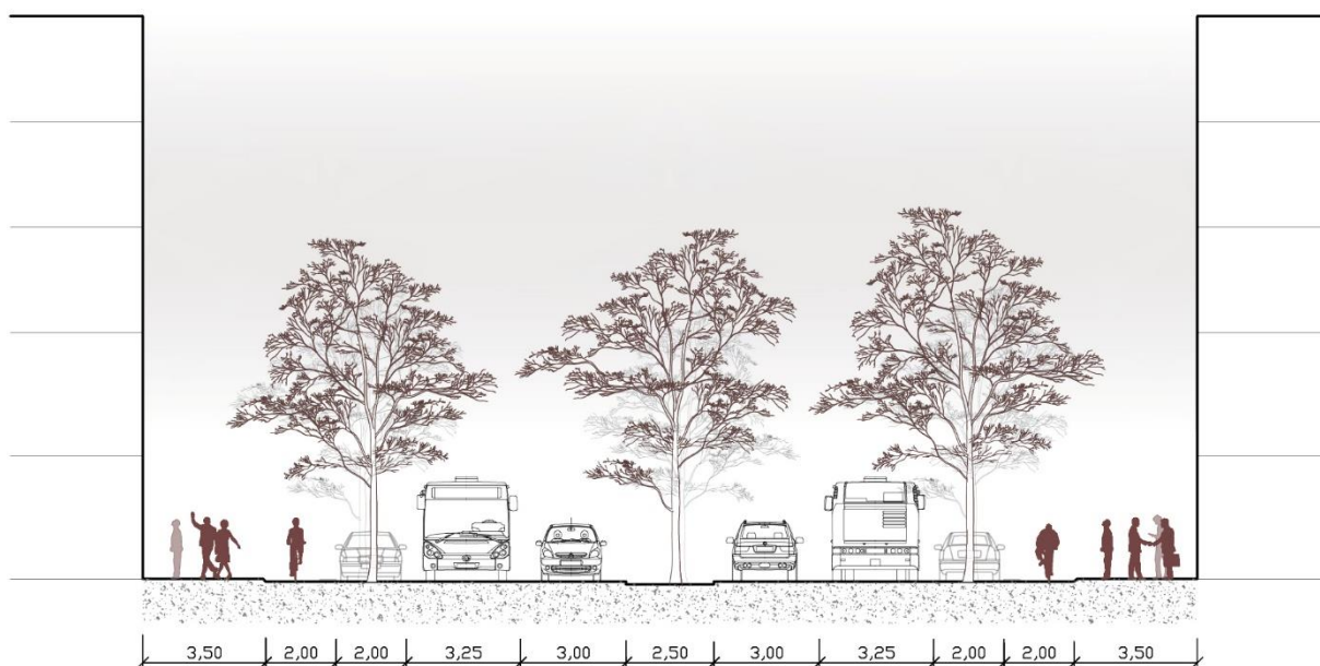
Obr. 19 Řez: možná varianta Brněnské třídy se středním dělicím ostrůvkem v celé délce a s cyklostezkou umístěnou v přidruženém dopravním prostoru.
