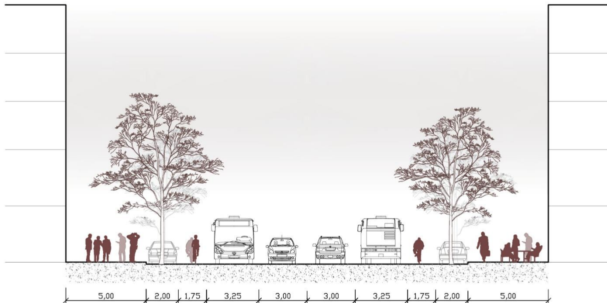
Obr. 16 Řez: možná varianta Brněnské třídy bez středního dělicího ostrůvku, s cyklostezkou umístěnou v hlavním dopravním prostoru.
