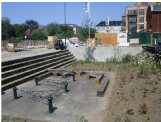
příklady retence v Kodani (v době sucha hřiště, v době retence zaplavená plocha)
