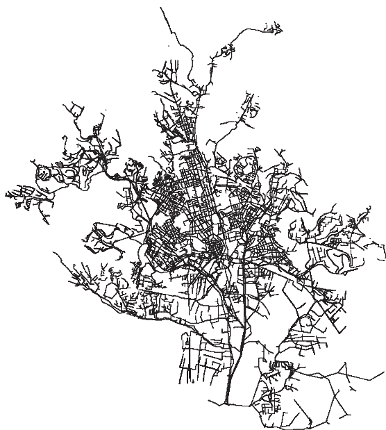
Obr. 2.2. Schéma souhrnného modelu stokové sítě v prostředí MOUSE DHI
