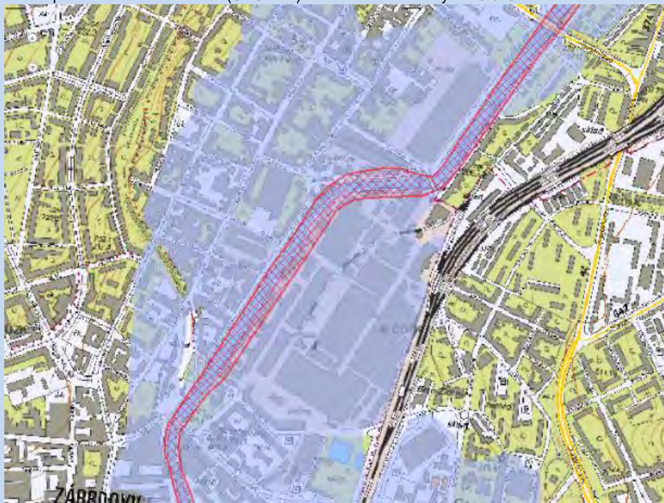
Záplavové území Svitavy Q100 s vyznačenou aktivní zónou v řešeném území (zdroj: VUV TGM)
