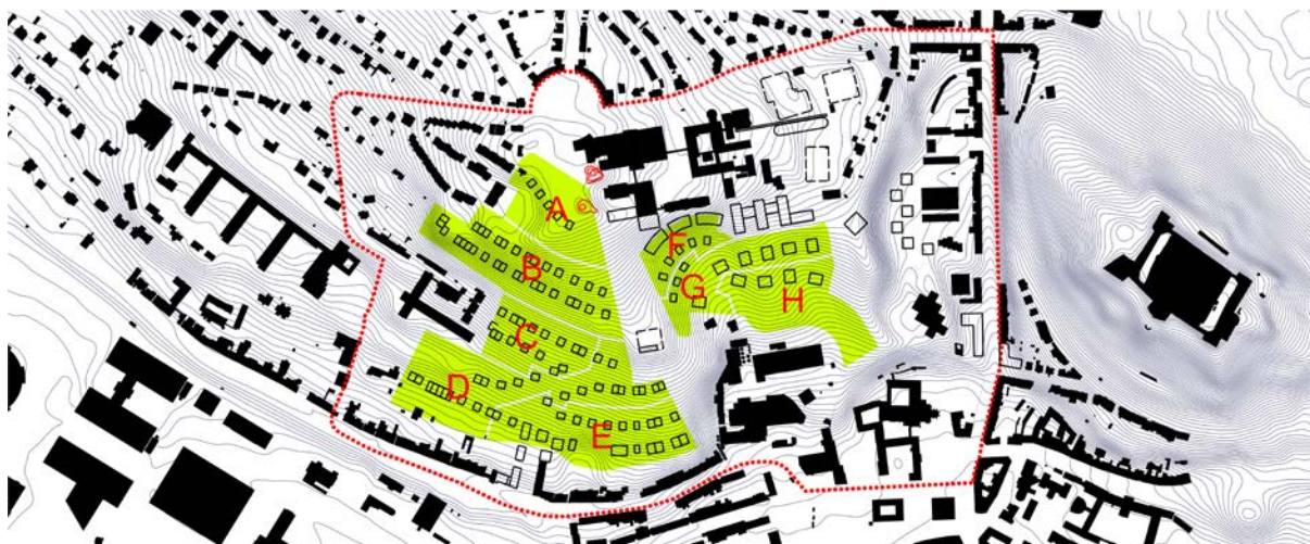
Obr.24) Situace zobrazující rozdělení území na jednotlivé oblasti pro výpočet generované dopravy
