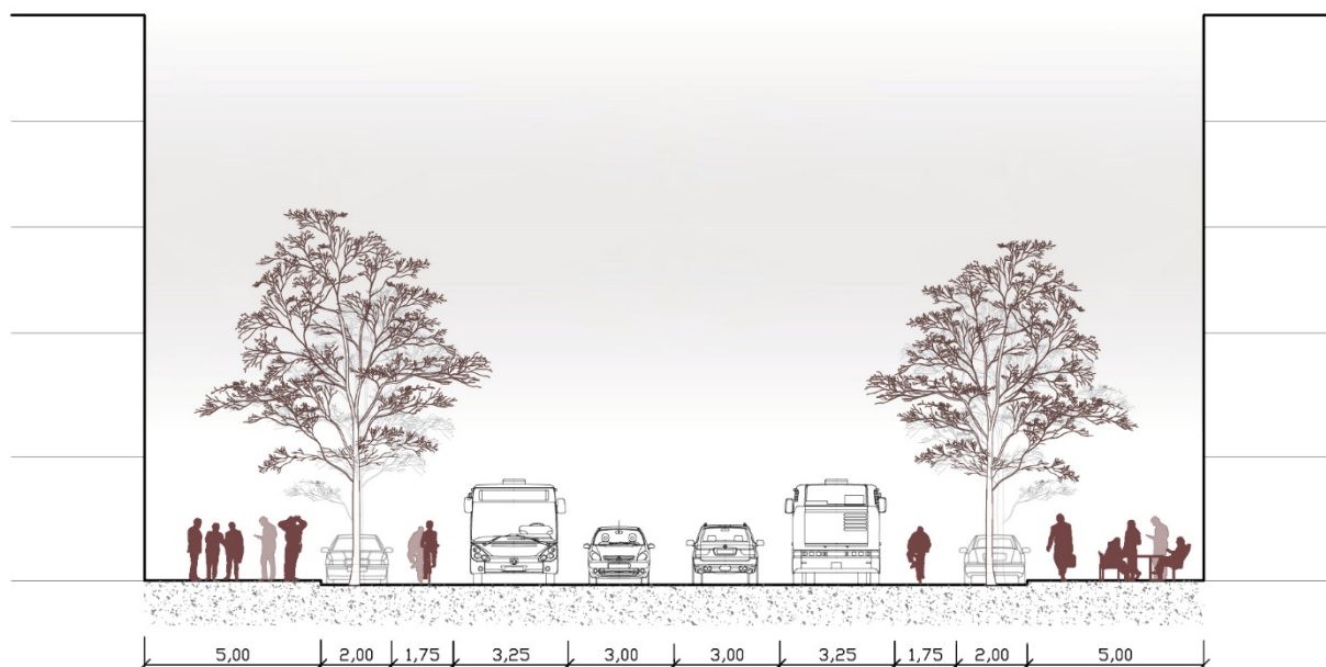
Obr. 14 Příklad možného příčného řezu komunikací Brněnská třída
