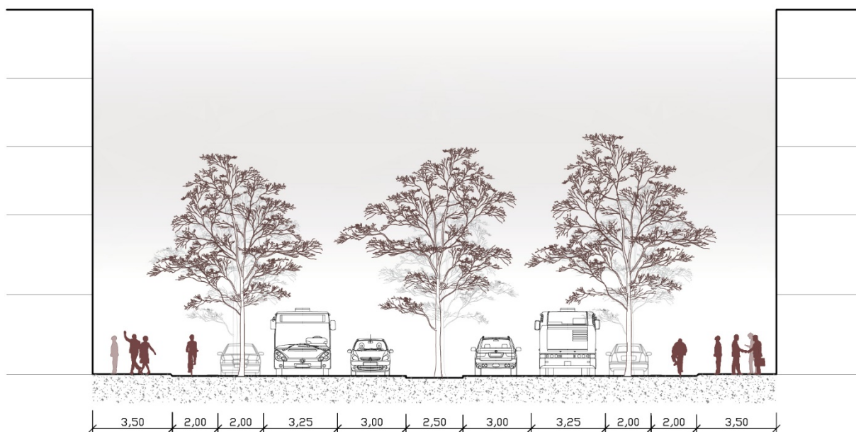
Obr. 18 Řez: možná varianta Brněnské třídy se středním dělicím ostrůvkem v celé délce a s cyklostezkou umístěnou v přidruženém dopravním prostoru.
