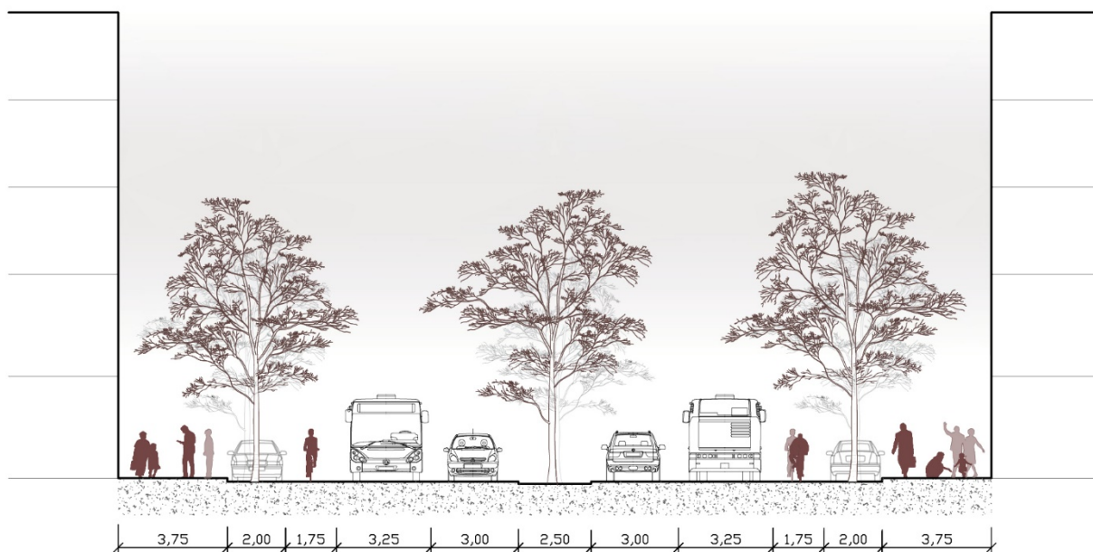
Obr. 16 Řez: možná varianta Brněnské třídy se středním dělicím ostrůvkem v celé délce a s cyklostezkou umístěnou v hlavním dopravním prostoru.
