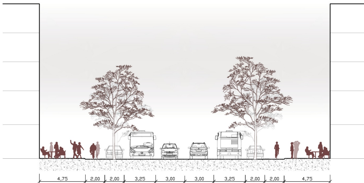
Obr. 17 Řez: možná varianta Brněnské třídy bez středního dělicího ostrůvku a s cyklostezkou umístěnou v přidruženém dopravním prostoru.
