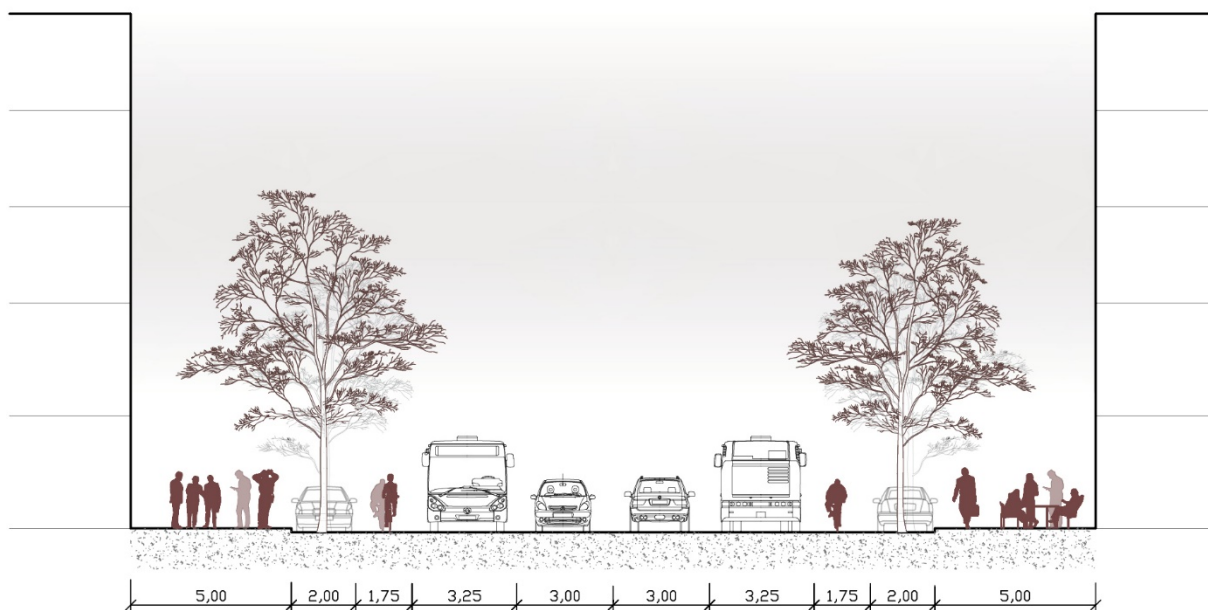
Obr. 15 Řez: možná varianta Brněnské třídy bez středního dělicího ostrůvku, s cyklostezkou umístěnou v hlavním dopravním prostoru.
